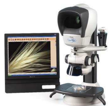
LYNX met tafelstandaard en optionele USB camera en X-Y tafel.
